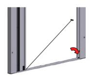
2.2.12. Kontrollieren Sie Polarität der Magnetleiste und dann befestigen Sie diese ins Profil.
