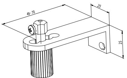
Spannwinkel einfach, 20 - 40 mm P032/1 (2-01649)
