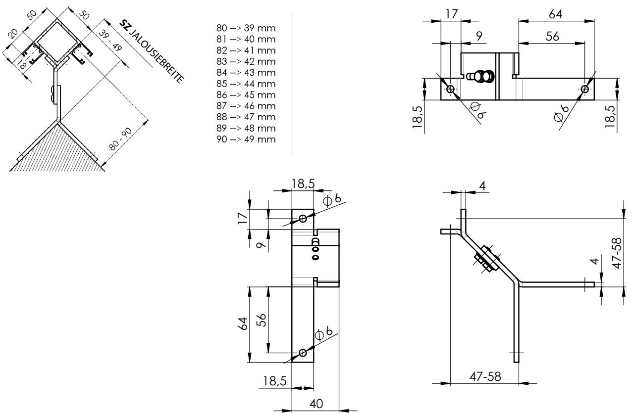
**Führungsschienenhalter, eckig außen 90-110 P098/5 2-01944-PU11**
