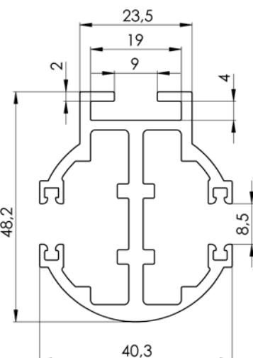
**Unterputz-Kasten P 018/31 (3-01419-0000) mit der Führungsleiste P 018/3X (7-302234-PU52)**
