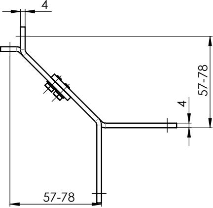
**Führungsschienenhalter, eckig außen 110-150 P098/6 2-01945-PU11**
