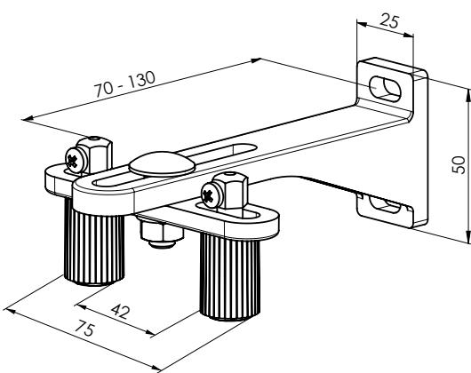
Spannwinkel doppelt, 90 - 165 mm P032/9 (2-01651)
