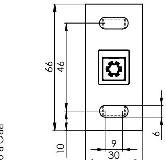
Führungsschienenthalter teleskopisch STS P021/5 (2-00582)
