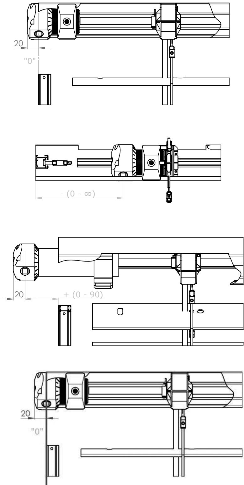
Die Getriebeposition (mögliche Verschiebung) in Oberschiene hängt vom jeweiligen Bestückung des Fensterrahmens, der Leibung ab. Die Getriebearchse ist der Abstand der Achse der Getriebemitte vom Außenrand der Führungsschiene, gegebenenfalls vom Außenrand der Lamelle bei der Stahlseilführung.
