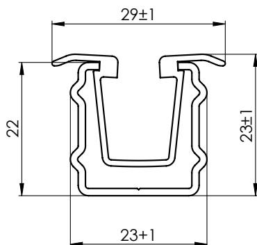
Die unterputz Führungsschiene ist auf zwei Teile geschnitten (300mm von oberer Kante) und ist mit Keder verbunden. Der Grund dafür ist das Aufsetzen auf die Führungsnippel und richtiger Einzug in die Führungsschiene. Der Keder ist nach der ganzen Länge der Führungsschiene.
