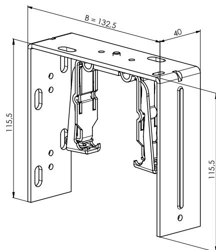
**Doppelhalter mechanisch - verstellbar lang 165 – 223 mm**
