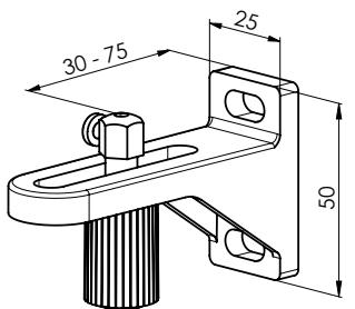
Spannwinkel einfach, 70 - 130 mm P032/3 (2-01647)
