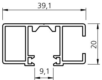
**Hänger der oberen Leiste mit dem Halter P 002/42 der Führungsleiste P016/1**
