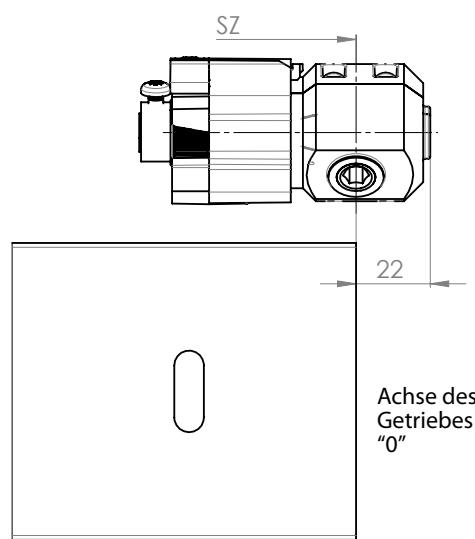
Getriebe für die Schnurbetätigung
