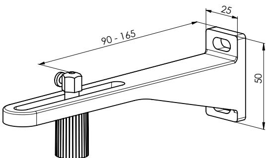
Spannwinkel einfach, 120 - 200 mm P032/5 (2-01645)
