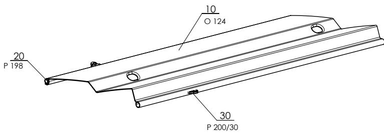
Typen der Führungen für durch Führungsschienen geführte Jalousien
