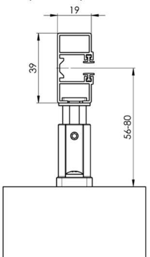
Führungsschienenthalter teleskopisch STS P021/6 (2-00583)
