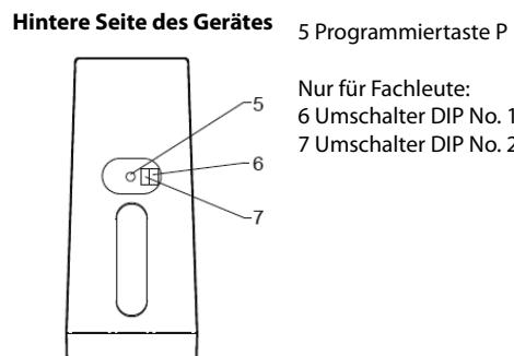
Entfernen Sie die Gummikappe von der Rückseite der Fernbedienung und schalten den Umschalter Nr. 2 in der Fernbedienung in die Position OFF um.
