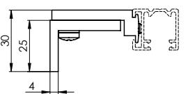
Führungsschienenthalter teleskopisch P021/4 (2-00402)
