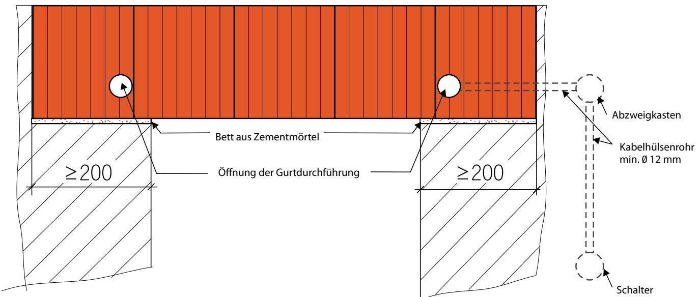
Bei der Kurbelbetätigung wird die Kurbel durch die vorbereitete Öffnung ins Jalousiegetriebe durchgesteckt. Dann in den Sturz schrauben.
