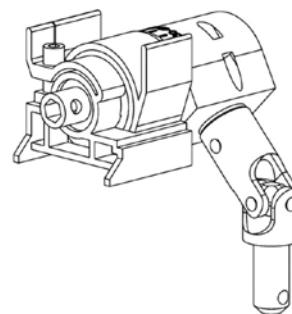
Getriebe mit Sechskantöffnung für die Kurbelbetätigung
