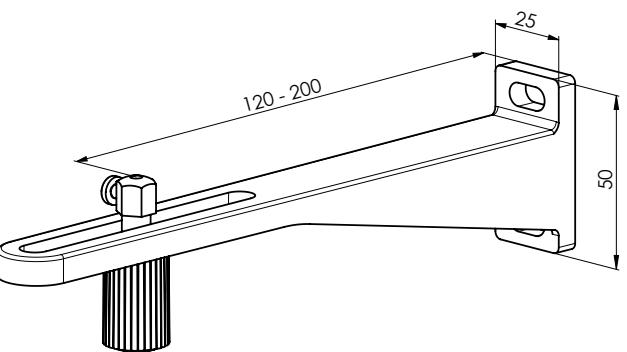
Spannwinkel doppelt, 40 mm P032/6 (2-01654)
