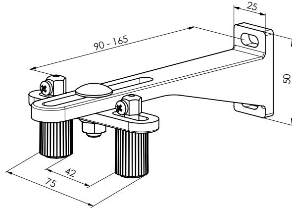
Spannwinkel doppelt, 120 -200 mm P032/10 (2-01650)
