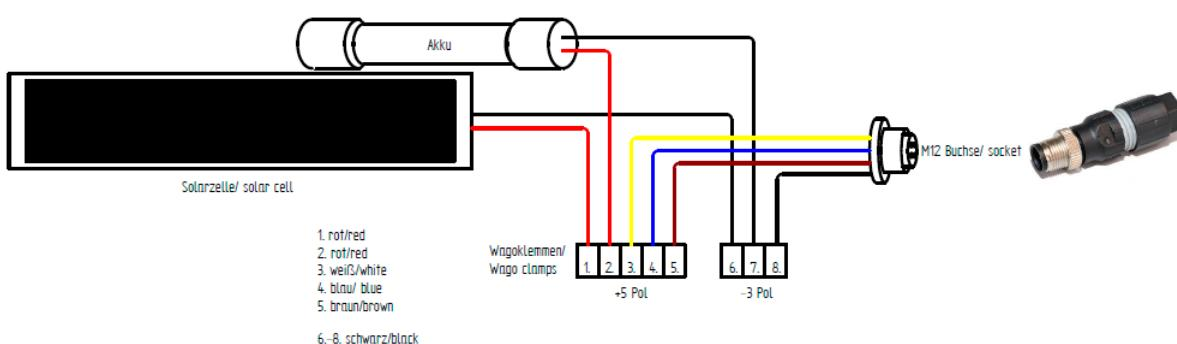
1) Verbinden Sie das Solarpanel mit dem Empfänger
