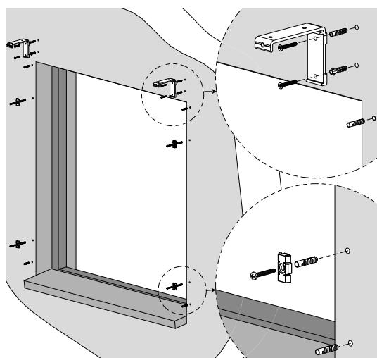
**Schritt 1: Bohren der Löcher für Montagebügel und Führungsschienen**
