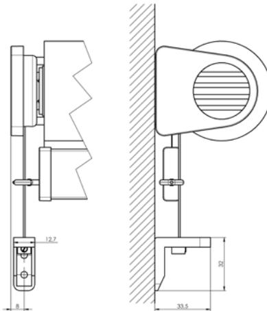
**Seilführung mit Seihalter für Montage in die Decke (L+K)**
