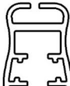
Unterleiste für Stoffbespannung RBR/1
