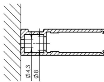
Führungsschiene von vorne ge bohrt (VL-L30c)
