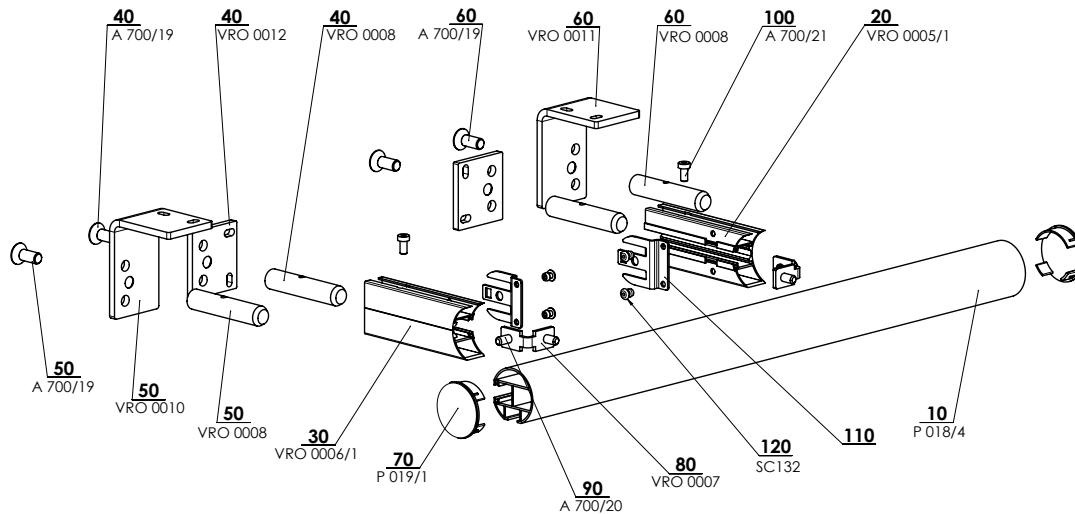
Rahmen mit der runden Führungsschiene
