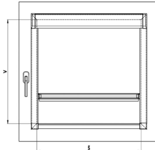
Die Ausmessung ist wie im Bild dargestellt durchzuführen. Die Messung soll oben an dem Rahmen des Fensterflügels, nicht an der Glasfläche, gemessen werden. Ist das Fenster mit einem Typenschild versehen, dann geben Sie die genaue Bezeichnung und Typ des Dachfensters im Bestellformular an. Die Mindesttiefe für die Montage ist 40 mm.
