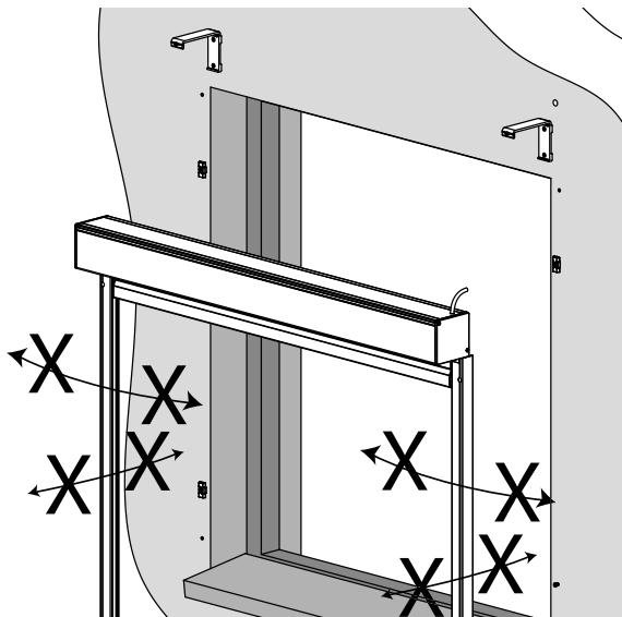
Achten Sie darauf, dass die Gleitblöckchen der Endleiste korrekt in den Führungsrillen der Schienen laufen.
