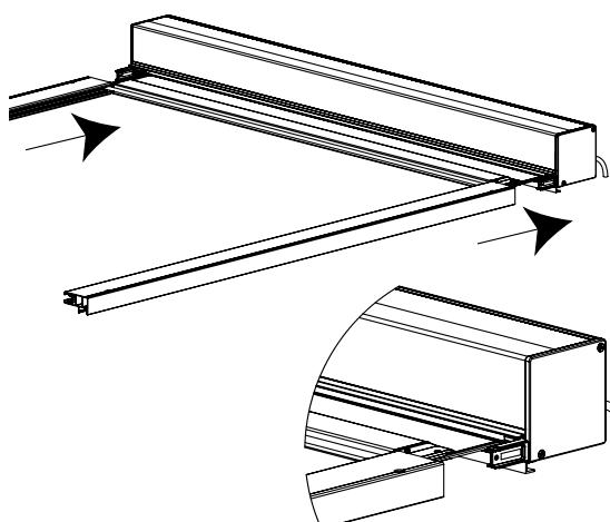
**Schritt 2: Schieben Sie die Führungsschienen unten am Kasten über die Konsolezapfen.**
