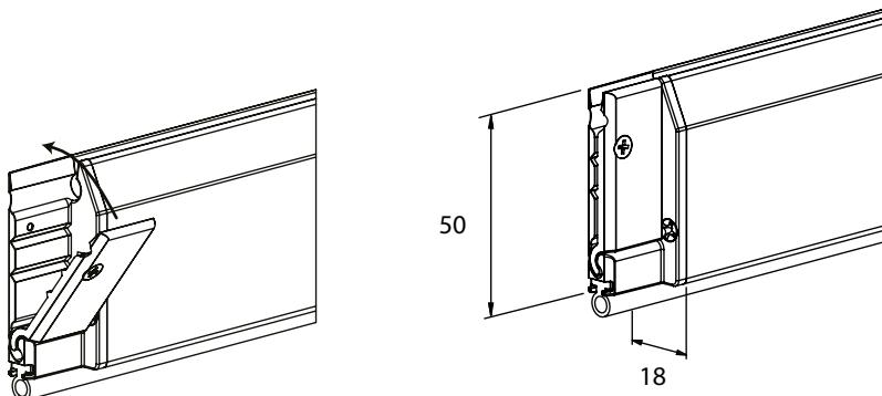
**Material: aus stranggepresstem Aluminiumprofil:**
