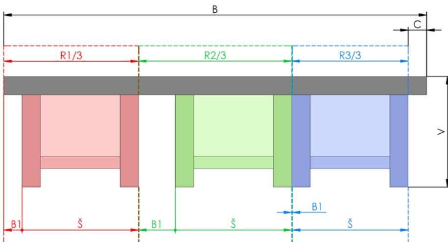
Das Rollo kann in die Öffnung oder vor die Öffnung (auf die Decke oder an die Wand) platziert werden.
