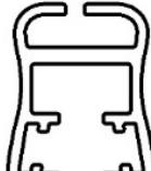
Unterleiste für Stoffbespannung RBR/1
