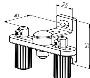
Spannwinkel doppelt, 48-75 mm P032/7 (2-01653)
