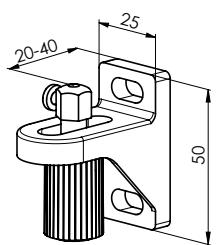
Spannwinkel einfach, 30-75 mm P032/2 (2-01648)
