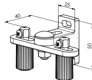
Spannwinkel doppelt, 48-75 mm P032/7 (2-01653)
