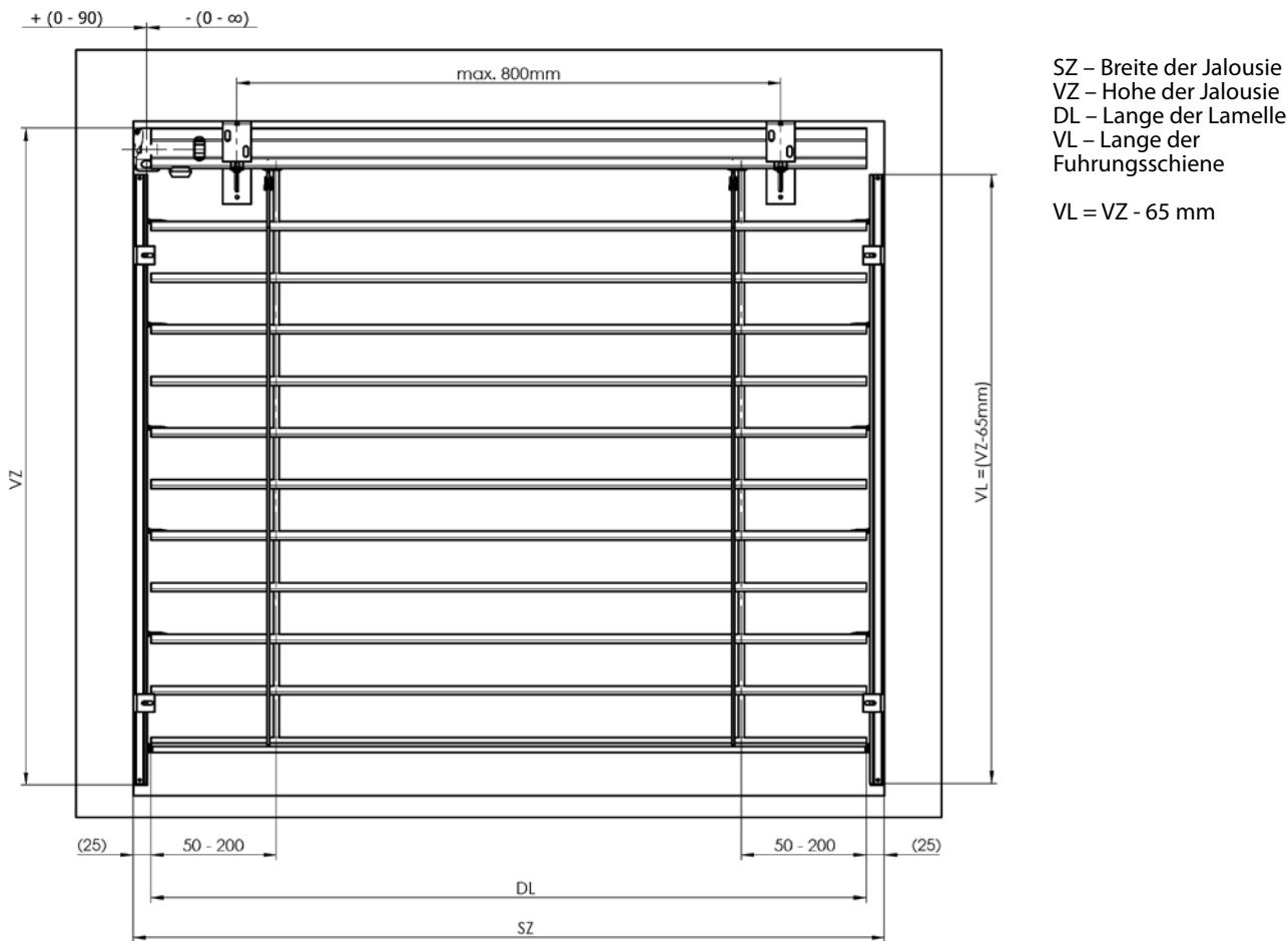
Die Oberschiene ist im Falle der Motorbedienung um 5 mm kurzer. Bei der Bedienung mit einer Kurbel ist die Länge der Oberschiene von der Getriebeverschiebung abhängig. Die Position des Getriebes (die mögliche Verschiebung) in der Oberschiene ist von dem konkreten Einbau des Fensterrahmens und der Ausmauerung abhängig. Der Abstand der Leiter ist von der Wahl der Bedienung abhängig (liegt in dem Bereich von 50 – 200 mm).
