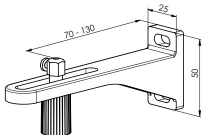
Spannwinkel einfach, 90-165 mm P032/4 (2-01646)
