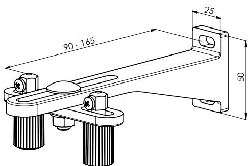
Spannwinkel doppelt, 120-200 mm P032/10 (2-01650)
