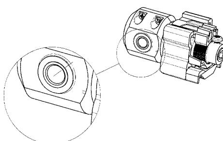
Getriebe für die Schnurbetätigung
