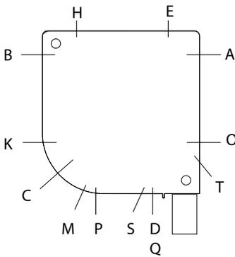
Abhängig von der Betätigung gibt es verschiedene Varianten von Ausgängen. Aus diesen Zeichnungen ist die exakte Position des Betätigungsausgangs ersichtlich. Beachten Sie diese Zeichnungen bei der Montage.
