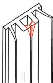
Die Führungsleiste schneiden Sie auf die richtige Länge so, dass der Rand vollkommen rechtwinkelig ist. Nach dem Abschneiden der inneren Kunststoffschiene sollen beide zwei oberen Profildenden so abgeschragt sein, wie auf dem Bild dargestellt ist, was eine Abreibung des Stoffes an der scharfen Kante verhindert.
