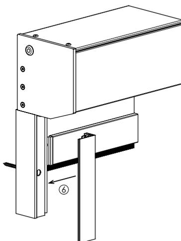
Die Deckleiste mit der Schraube sichern.
