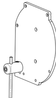
Schrauben Sie die Konsolen mithilfe von für den Konstruktionstyp (Stahlkonstruktion, Zement, Mauerwerk u.ä.) geeigneten Schaftschrauben und Einzelteilen an die Wand. Im Bedarfsfall vergrößern Sie den Abstand zwischen der Konsole und der Wand mithilfe von Unterlegscheiben. Das Seil spannen Sie immer an und halten so, dass es sich nicht verdreht.
