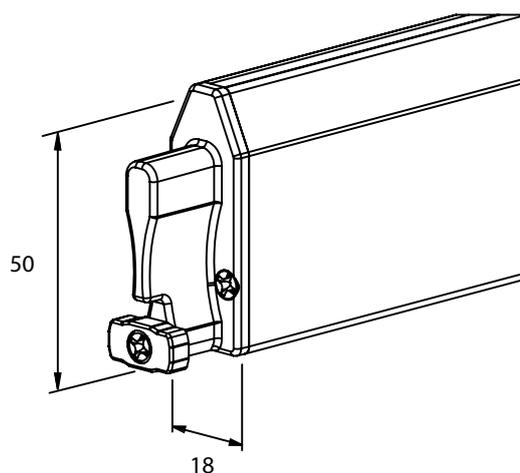
Material: aus stranggepresstem Aluminiumprofil:
