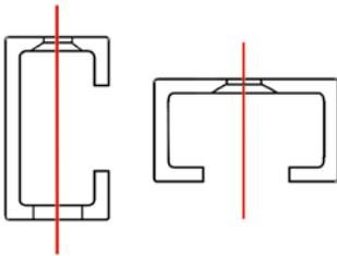
Die markierte rote Linie bezeichnet die vertikale Achse für die Montageschrauben. Verwenden Sie die ausgebohrten Führungsleisten als Schablone zur Übertragung der Position der Öffnungen an die Wand des Fensterflügels.
