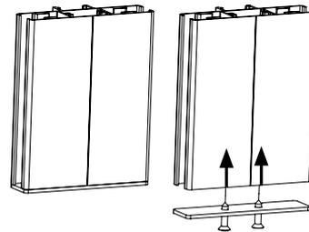
Mit Endanschlag (Material: Aluminium, Materialstärke: 2 mm) für die Unterleiste am unteren Ende der Schiene.
