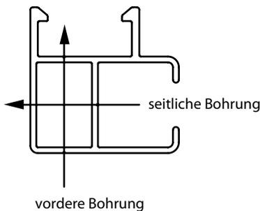
Führungsschienen für seitlicher oder rückwärtiger Bohrung
