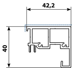
Das richtige Vorgehen bei der Montage der Führungsleisten hängt von dem verwendeten Modell des Kastens und noch davon ab, ob der Kasten an die Decke oder die Wand montiert wird oder ob er direkt an den Führungsleisten befestigt ist. Im Angebot ist nur ein Modell der Führungsleisten enthalten, und zwar der Typ GS40.
