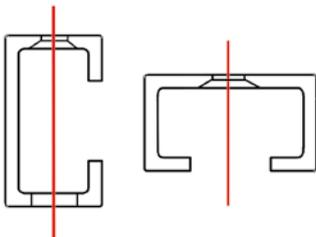
Die markierte rote Linie bezeichnet die vertikale Achse für die Montageschrauben. Verwenden Sie die ausgebohrten Führungsleisten als Schablone zur Übertragung der Position der Öffnungen an die Wand des Fensterflügels.
