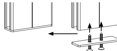
An der Unterseite mit einem kunststoff Endstopfen oder einer aluminium Endplatte als Anschlag für die Endleiste, Dicke 2 mm.
