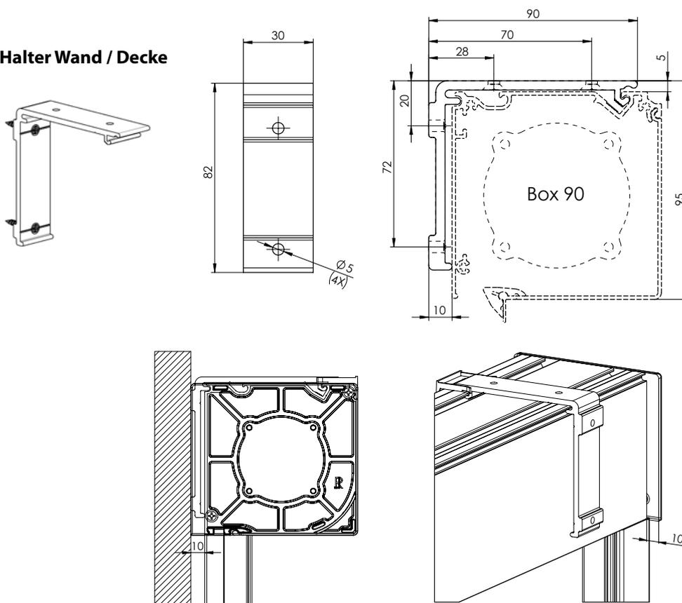
Der Spalt 10 mm für Alpha bei Verwendung der Halter Wand-/Decke für alle Größen
