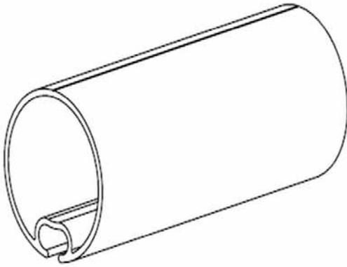
Material: verzinkter Stahl für Rohre  $\varnothing 95$  mm.
