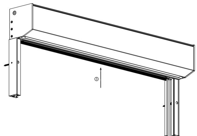
Den Stoff in den Führungsschienen einführen.
