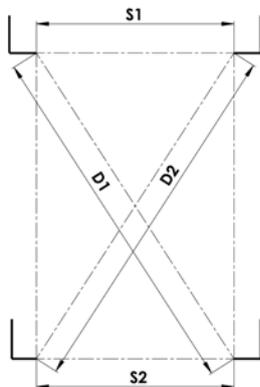
Zur Fertigstellung der Montage überprüfen Sie, ob die Führungsleisten parallel und rechtwinklig sind. Dies kann man durch die Messung von zwei Abständen „S1“ und „S2“ oder der Diagonalen „D1“ und „D2“ vornehmen. Die Abstände müssen gleich sein bei  $\pm 2\text{mm}$ . Die richtige Anordnung der Führungsleisten ist notwendig, um die richtige Funktion des Rollos zu gewährleisten; sonst kann die Funktion gestört sein.
