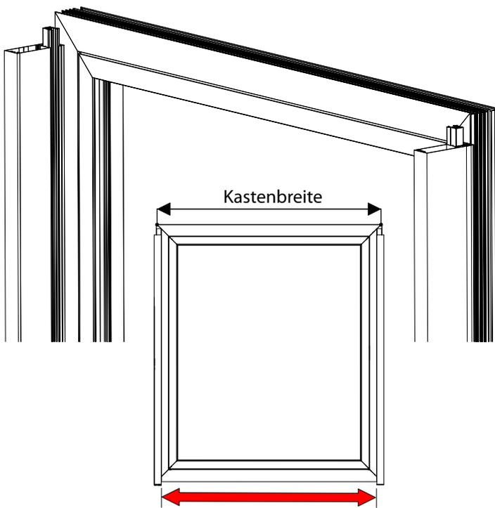
Abstand zwischen Führungsschienen = Kastenbreite - 80 mm
