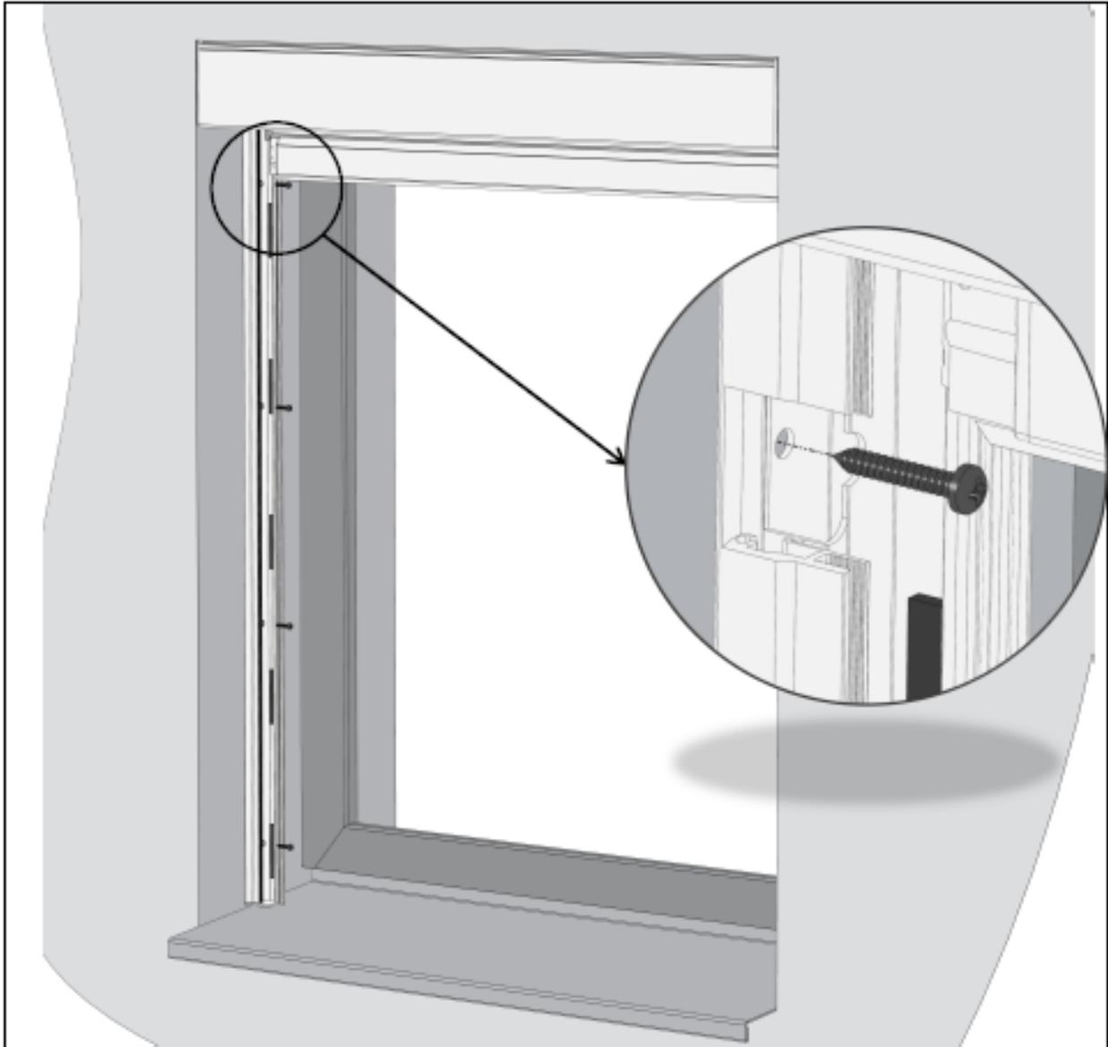
1.b Frontmontage der Führungsleisten
