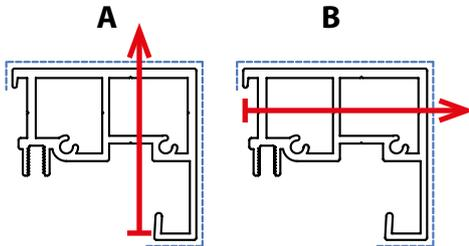
Die markierte rote Linie bezeichnet die vertikale Achse für die Montageschrauben. Verwenden Sie die ausgebohrten Führungsleisten als Schablone zur Übertragung der Position der Öffnungen an die Wand des Fensterflügels.
