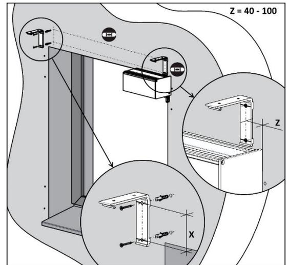
**Schritt 2: Installation der Box auf den Halter Wand/Decke**
