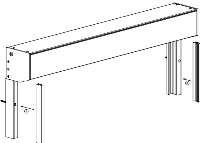
Die Kunststoffführungsschienen einsetzen
