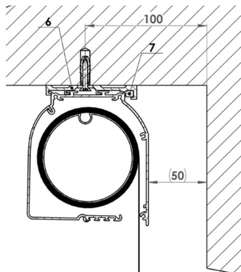
Setzen Sie den oberen Kasten auf die Konsolen auf und schieben ihn in Längsrichtung, bis er im Rahmen des Fensterflügels zentriert ist, und drücken Sie die Keile (7) zur Sicherung des Kastens an seinem Ort ein.
