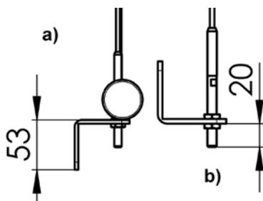
Die unteren Konsolen können seitlich oder frontal montiert werden, wobei das Profil „L“ nach unten (a) oder nach oben (b) zeigt.
