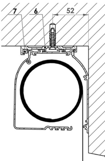
Montieren Sie die Konsolen (6) mithilfe von für den Konstruktionstyp (Metallkonstruktion, Fensterrahmen, Wand oder anderes Material) geeigneten Schaftschrauben und Einzelteilen. In den Fällen, in denen vier Konsolen verwendet werden, stellen Sie sicher, dass die Konsolen vollkommen ausgeglichen sind ( $\pm 1$  mm); das kann durch ein Verschieben des Kastens an den Ausschnitten vor dem Anziehen der Befestigungsschrauben kontrolliert werden.
