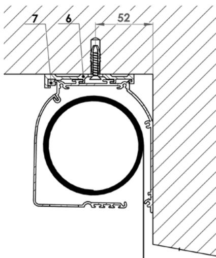
Montieren sie die Konsolen (6) mithilfe von für den Konstruktionsstyp (Metallkonstruktion, Fensterrahmen, Wand oder anderes Material) geeigneten Schaftschrauben und Einzelteilen. In den Fällen, in denen vier Konsolen verwendet werden, stellen sie sicher, dass die Konsolen vollkommen ausgeglichen sind ( $\pm 1$  mm); das kann durch ein Verschieben des Kastens an den Ausschnitten vor dem Anziehen der Befestigungsschrauben kontrolliert werden.
