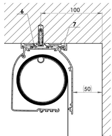
Setzen Sie den oberen Kasten auf die Konsolen auf (6) und schieben ihn in Längsrichtung, bis er im Rahmen des Fensterflügels zentriert ist, und drücken Sie die Keile (7) zur Sicherung des Kastens an seinem Ort ein.
