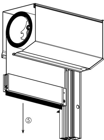
Die Führungsschienenendkappen einsetzen.
