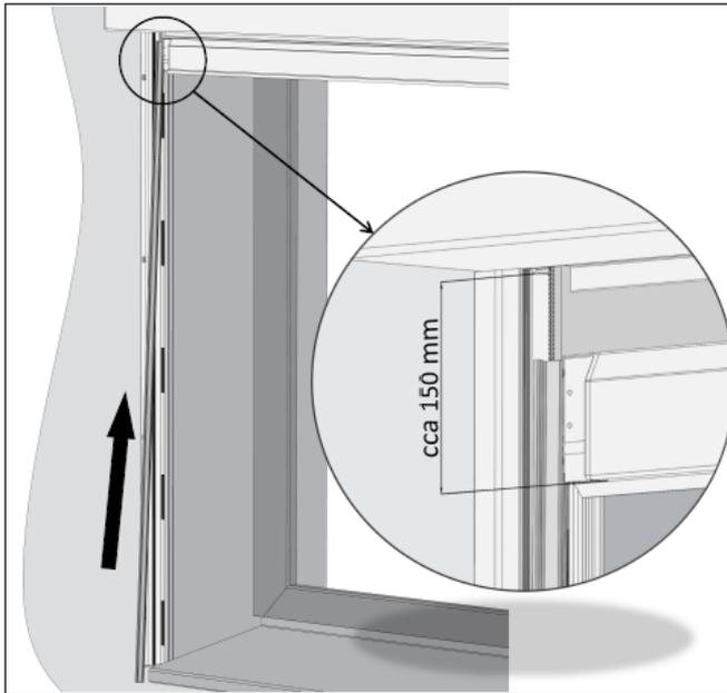
Schnitt durch die Leiste A840-1 nach dem Aufsetzen des Zipp-Profiles
