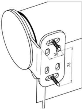
Die Montage des Screenrollos an die Decke beginnt man mit der Ausmessung der Befestigungsöffnungen für die Tragkonsolen.
