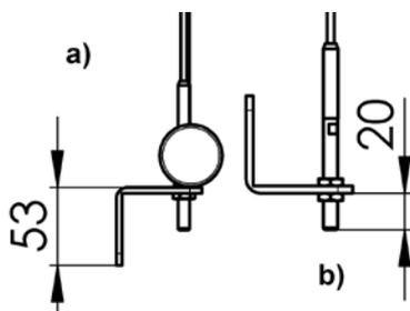
Die unteren Konsolen können seitlich oder frontal montiert werden, wobei das Profil „L“ nach unten (a) oder nach oben (b) zeigt.
