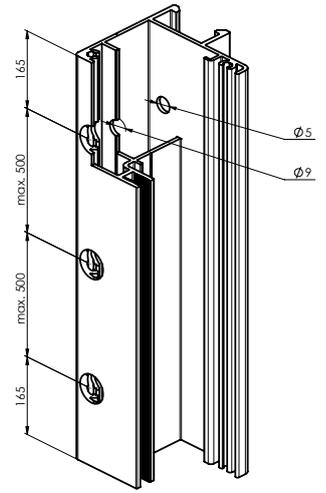
Halter für die Führungsleisten A828 und A838, A837:
