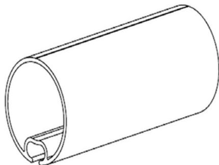
Material: extrudiertes Aluminium für Rohre  $\varnothing$  55mm und  $\varnothing$  67mm und verzinkter Stahl für Rohre  $\varnothing$  85 mm a  $\varnothing$  100 mm.
