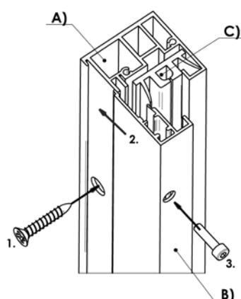
Die Führungsleisten ZIP bestehen aus drei Teilen: aus zwei Alu-Schienen und einer Innen-Kunststoffschiene, in welcher sich der ZIP bewegt.
