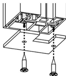
Wenn die Führungsleisten mit ihrem Rand nicht auf der Fensterbrüstung oder dem Fußboden stehen, müssen an den Enden die Endkappen verwendet werden. Vor dem weiteren Montageschritt befestigen Sie die Endkappen mithilfe von gelieferten Schrauben.
