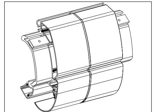
Kopplung Fallstange Variovolant
