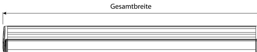
Ausfall U: gemessen von der Rückseite des Kastens (oben) bis zur Vorderseite der Fallstange. Eine montierte Markise ragt stets ein wenig mehr hinaus (Montageabstand Mauer) als der angegebene Ausfall.
