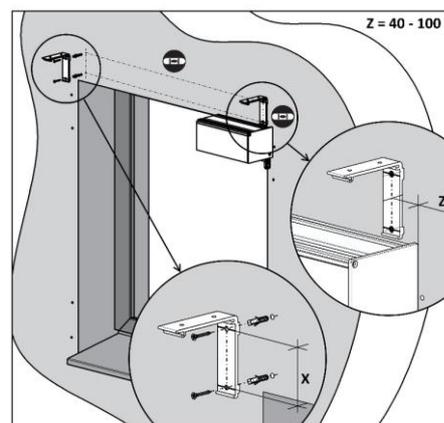
Bei der selbsttragenden Ausführung lassen Sie den Schritt 1 aus und setzen mit dem Schritt 2 fort.
