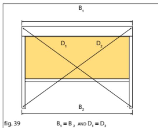
Wenn die Box und die Führungsleisten nicht richtig montiert sind, dann wird sich die untere Leiste immer schräg in die Box einwickeln, wodurch der Stoff wellig werden kann oder aus der Kunststoffeinlage in der Führungsleiste herausgerissen werden kann.
