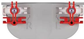
3 Durch mäßiges Öffnen der Schelle rasten die Schrauben in die Schraubenführung sicher ein und in dieser Position können sie dann auch über der Kopfhöhe in die obere Verglasungsleiste installiert werden.
